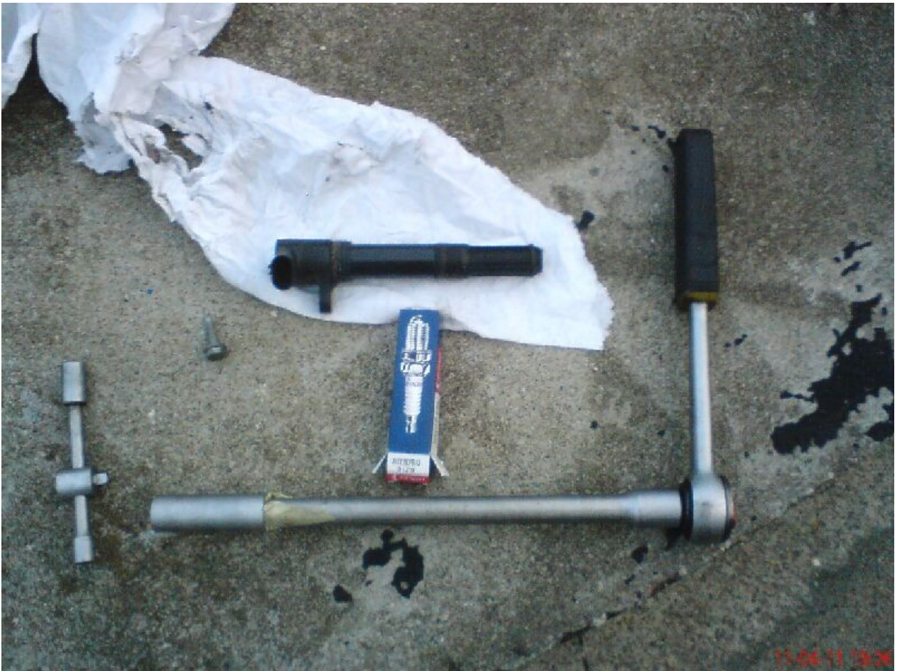
Widok narzędzi potrzebnych do przeprowadzenia wymiany świec. Główne narzędzie to klucz 1/2 cala z nasadką 16.
